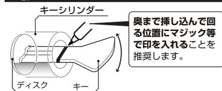
(Fig,2-1) ワンタッチロック構造
