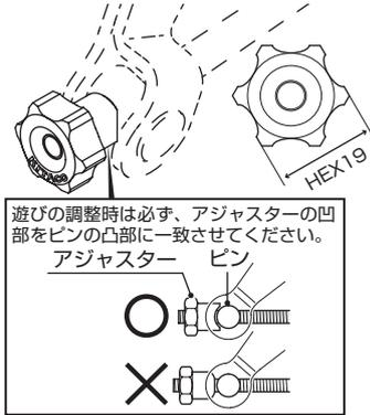
遊びの調整時は必ず、アジャスターの凹部をピンの凸部に一致させてください。
