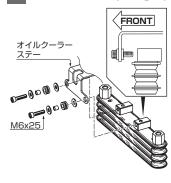
3-3 取付位置を決めてからオイル ホースを適度な長さに切って パーツのオイル取り出し箇所に つなげて下さい。オイルホースは マフラーやエンジンに接触しな いように取り回して下さい。 バンジョーボルト締付トルク:
