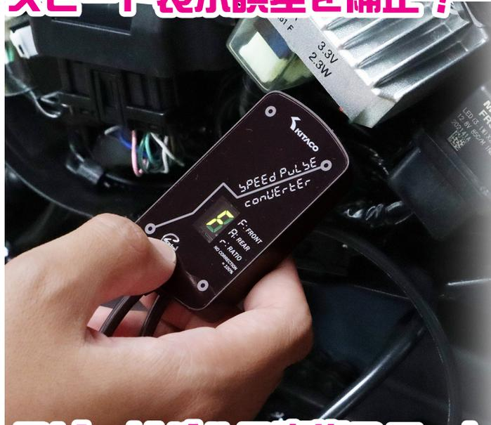
スプロケットの丁数組み合わせ変更や、タイヤサイズ変更で生じるスピードメーターの速度表示誤差を補正するアイテムです。取り付けはコネクタを外し割り込ませるだけ、ハーネス加工はいらぬ親切設計です。
