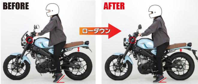
ローダウンリンクプレート交換と同時にフロントフォークの突き出しの変更が必要です。
