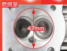
燃焼室容積のコンパクト化により、火炎伝播距離を短縮させたクロスフロー式燃焼室形状。
