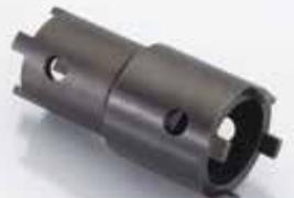
ホンダ系ミッション車のクラッチセンターロックナット脱着の際に必要な専用工具です。クラッチアウターホルダーと共に使用して下さい。1/2 インチ (12.7mm) トルクレンチを使用して下さい。
