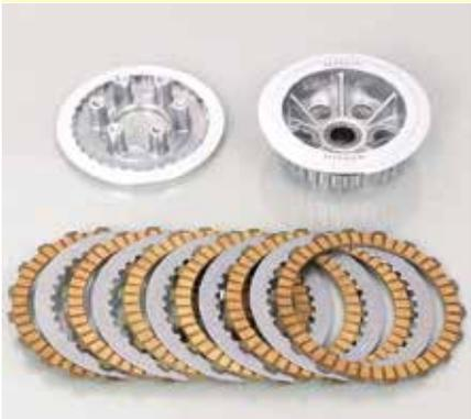
ノーマルクラッチのディスク数を増やす事でクラッチ容量が向上。滑りを抑制し、耐久性を向上させます。
