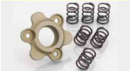
強度アップしたジュラルミン製クラッチリフターに加え、強化クラッチスプリングを付属させた SET です。
