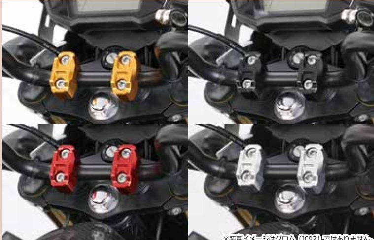
○アルミ削り出し ○アルマイト仕上げ ○2ヶ1SET ○取付ピッチ: 32.6mm ※ノーマルハンドルホルダー専用
