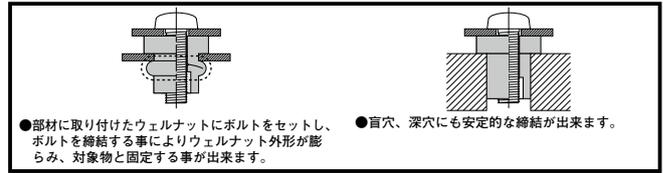
●部材に取り付けたウエルナットにボルトをセットし、ボルトを締結する事によりウエルナット外形が膨らみ、対象物と固定する事が出来ます。
