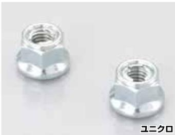
SURFACE HOLLOW 構造とは SMART NUT を締め付けると、ナットの下面側に設けられたねじ孔に連通する座繰り部が、ナット座面の片当たりを吸収し、ボルトを曲げることなく締め付けることができます。ナットの座面の片当たりを吸収することで、座面全体に均一な圧力をかけることができ、偏荷重 (不均等な偏った荷重) の原因を無くします。それにより、高い締め付けトルクで、SMART NUT を取り付けることが可能となりボルトの軸力の低下を抑え、高い域での安定した軸力保持を可能にします。また、ボルトへの偏荷重を抑えることは、ボルトの折損事故を大幅に防ぐことを可能にします。
