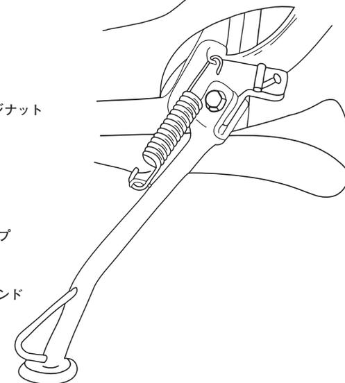
※取り付けの際は、スタンドの足を横に跳ね上げた状態でスプリングを取り付けて下さい。
