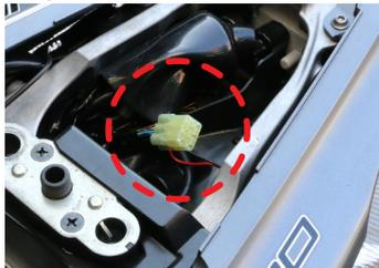
タンデムシートを開けコネクターカバー内の 6P 防水カプラーのキャップを外します。
