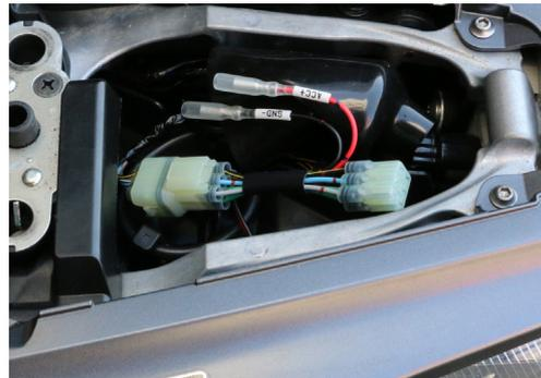
外した防水カプラーに電源取り出しハーネスを接続します。使用する USB 電源等を ACC ⊕ GND ⊖ に繋ぎ作業は終了です。
