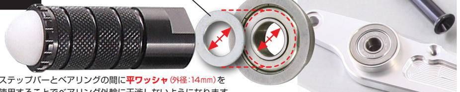
ステッパとベアリングの間に平ワッシャ(外径:14mm)を使用することでベアリング外輪に干渉しないようになります。
