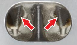
**2, バルブガイド、バルブシートリングの材質変更!!**
