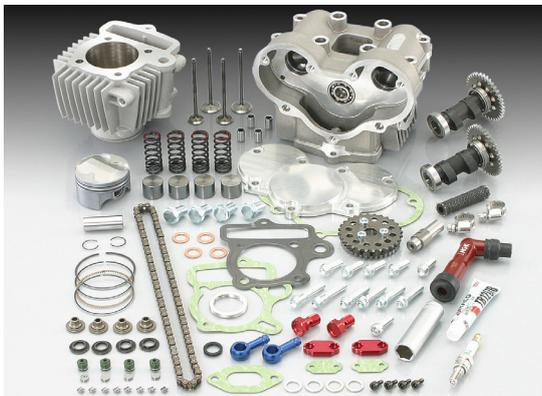
モンキー系横型エンジンの究極チューン、DOHC ポアアップ KIT です。4 サイクルチューンのノウハウを活かし、一から設計した非常にコンパクトな DOHC4バルブシリンダーヘッドはモンキーノーマルボディへの搭載を可能にしました。
