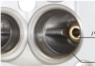
バルブガイドとバルブシートリングの材質を変更し、より耐久性を向上させています。
