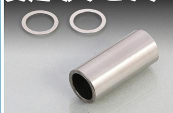
プーリーのセンターに位置するプーリーボスの長さを変える事によって、ドライブベルトをよりプーリーの外側に移動させる事が可能になり、最高速アップが望めます。また、2枚付属しているシムの取付位置により、細かな特性のセッティングが可能です。
