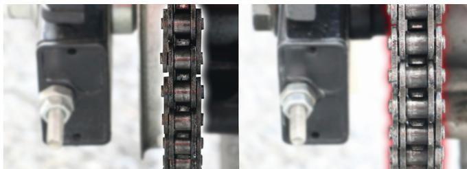
**420 サイズ** (ローラーリンク内幅: 6.35 mm)    **428 サイズ** (ローラーリンク内幅: 7.94 mm)
