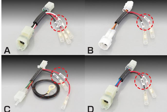
生活必需品のモバイル携帯等、充電に必要な電源確保に！メーカー車種ごとに合わせた、指定のカプラーに割り込ませるだけで ACC ⊕、アース ⊖ を取り出せます。
