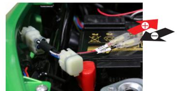
外した防水カプラーに電源取り出しハーネスを接続します。使用する USB 電源等を [ACC ⊕] [GND ⊖] に繋ぎ作業は終了です。
