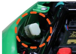
シート下の 4P 防水カプラーのキャップを外します。
