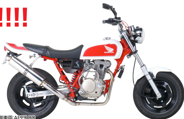
計測車両: APE100 DOHCボアアップKIT145cc (PWKφ28MビッグキャブKIT+パワーレブ type2+ハイエンドマフラーφ80) DOHCボアアップKIT125cc (VMφ26ビッグキャブKIT+レーシングテーパーエンドダウンマフラー)
