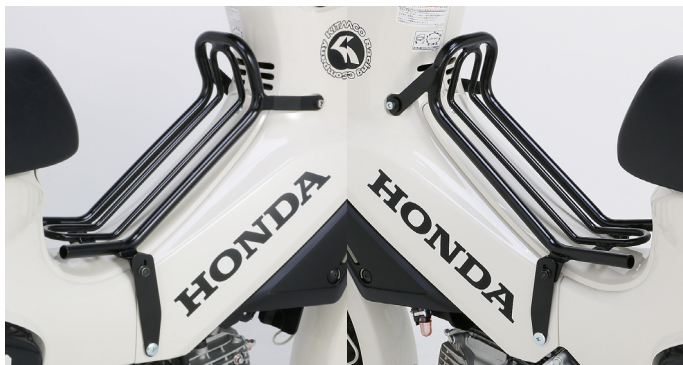
メインフレームにはφ16.0のパイプ採用。センターキャリアーをリリース
