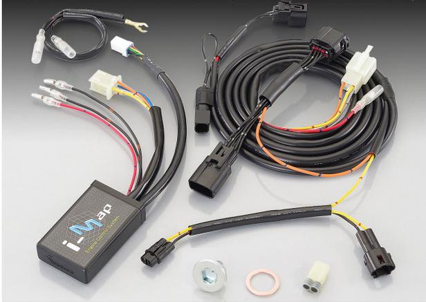
FI車のチューニングに必要な燃料噴射を補整するi-mapインジェクションコントローラーが、配線加工無しカプラーオンで簡単装着出来ます。
